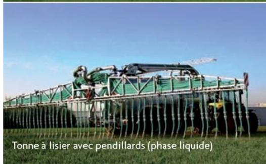
Tonne à lisier avec pendillards (phase liquide)
