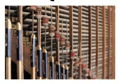
La mécanique permet l'ouverture des soupapes lorsqu'est joué le clavier. Elément essentiel de la transmission, l'abrégé permet de passer de la largeur des claviers à celle des sommiers. Des tiges plates en bois, appelées vergettes, relient les rouleaux de l'abrégé (tiges métalliques pivotantes) aux touches du clavier d'un côté et aux soupapes de l'autre.
